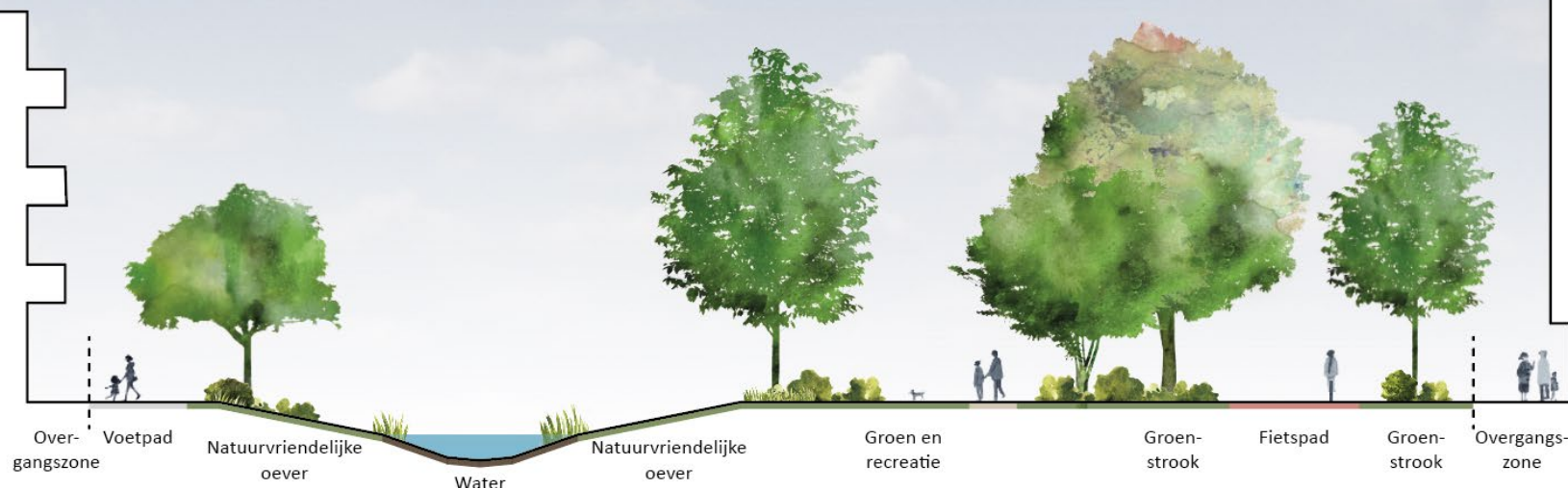
Figuur 2: Voorbeeldprofiel voor de groene en recreatieve hoofdstructuur in wijk. Om alle functies een plek te geven is een gemiddelde breedte nodig van meer dan 80 meter. De benodigde breedte van het profiel is ook afhankelijk van de hoogte van de omliggende bebouwing en de overgangszone tussen openbaar en privé.
